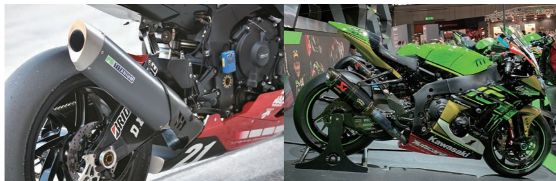
全日本選手権2018年の最終戦、鈴鹿大会。チャンピオンマシンに採用されているFGチタンサイレンサー。もはや、ブランドになっていると言える
