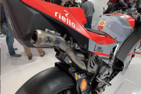
ドゥカティ、デスモセディチGP18のエキゾーストパイプ。このエキゾーストパイプにFGチタンの加工が施されていることは、あまり知られていない
